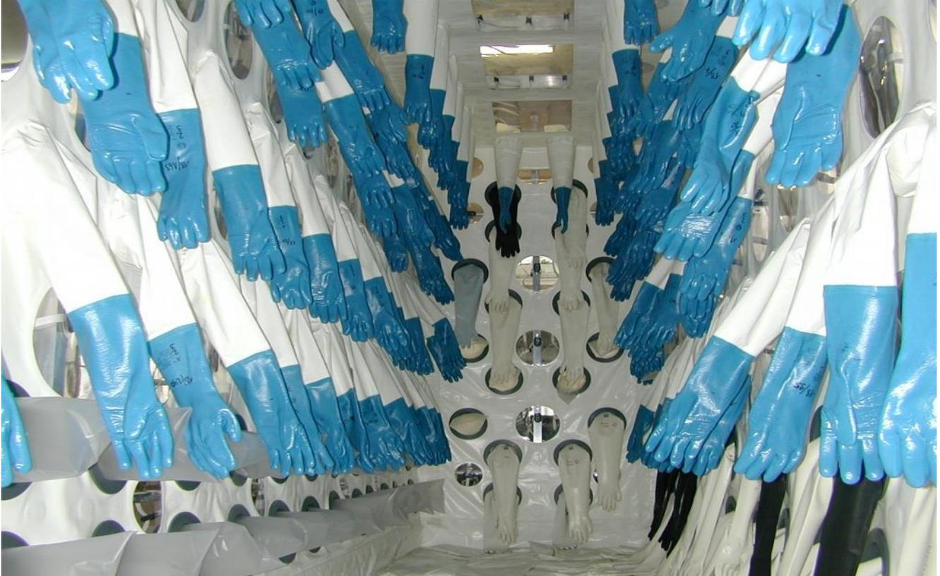
Glove-Box-Handschuhe erlauben das sichere Hantieren im Inneren einer Handschuh-Box. Typische Einsatzgebiete dieser Spezialhandschuhe sind:
